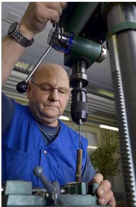
Ueli Bärtschi bohrt die Löcher 6 Zentimeter tief.
